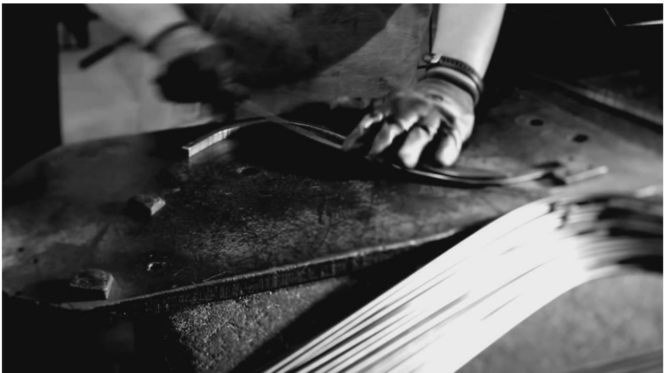
Dime per la piegatura a mano del filo metallico (Courtesy Knoll Archives).
