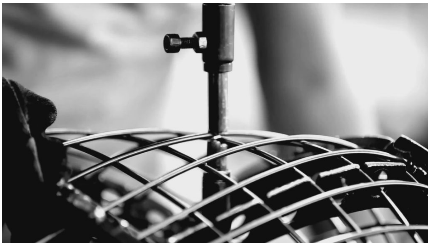
La saldatura a punti del reticolo (Courtesy Knoll Archives).
