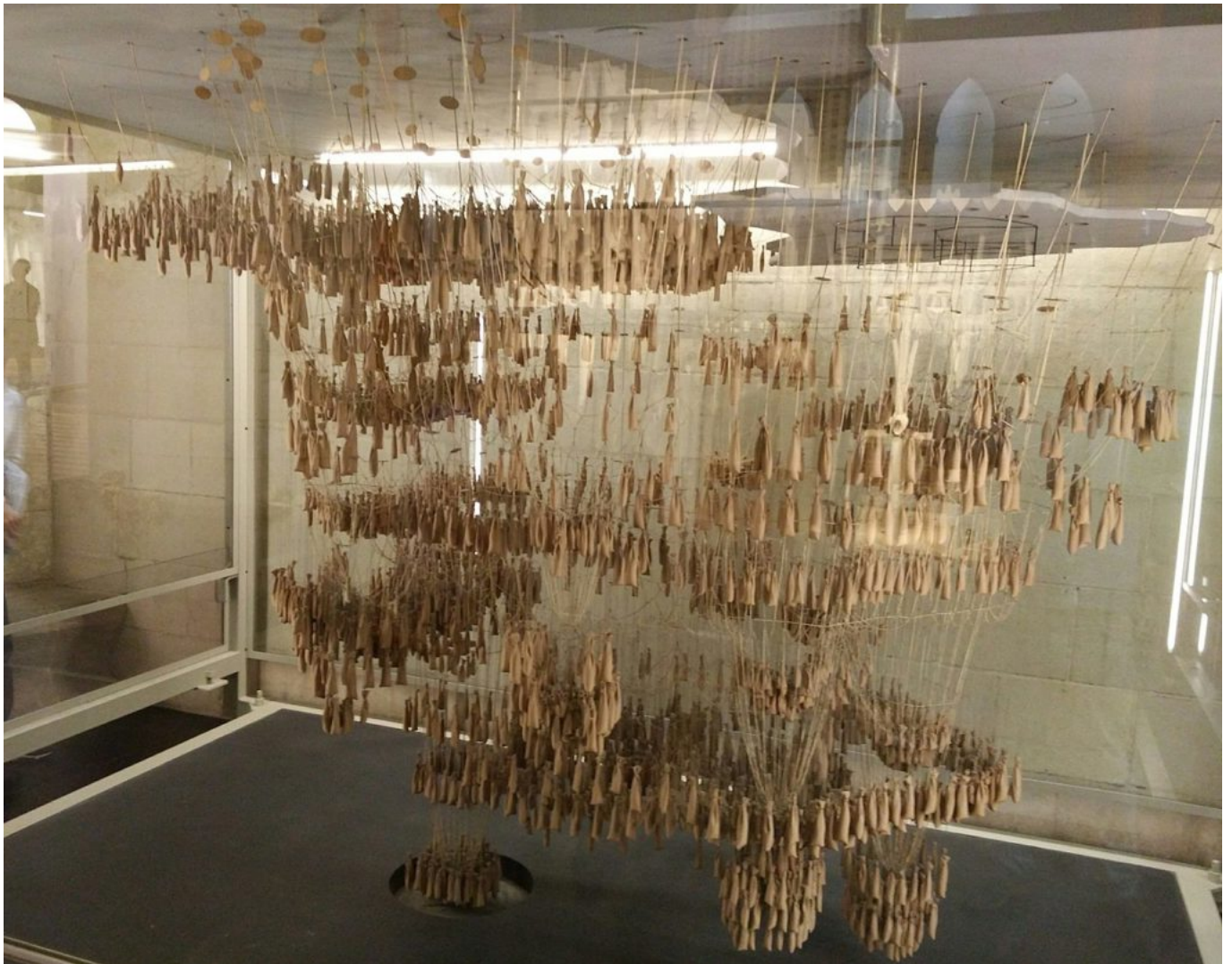
Modello della incompiuta chiesa della Colonia Güell realizzato da Gaudí con funi e pesi pendenti, oggi custodito nel Museo del Tempio della Sagrada Família, Barcellona (Javiermes/Wikimedia Commons).
